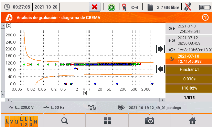
Fig. 32. Análisis de registro - diagrama CBEMA.
