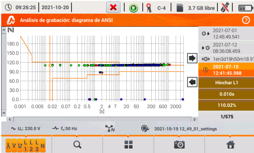
Fig. 31. Análisis de registro - diagrama ANSI.
