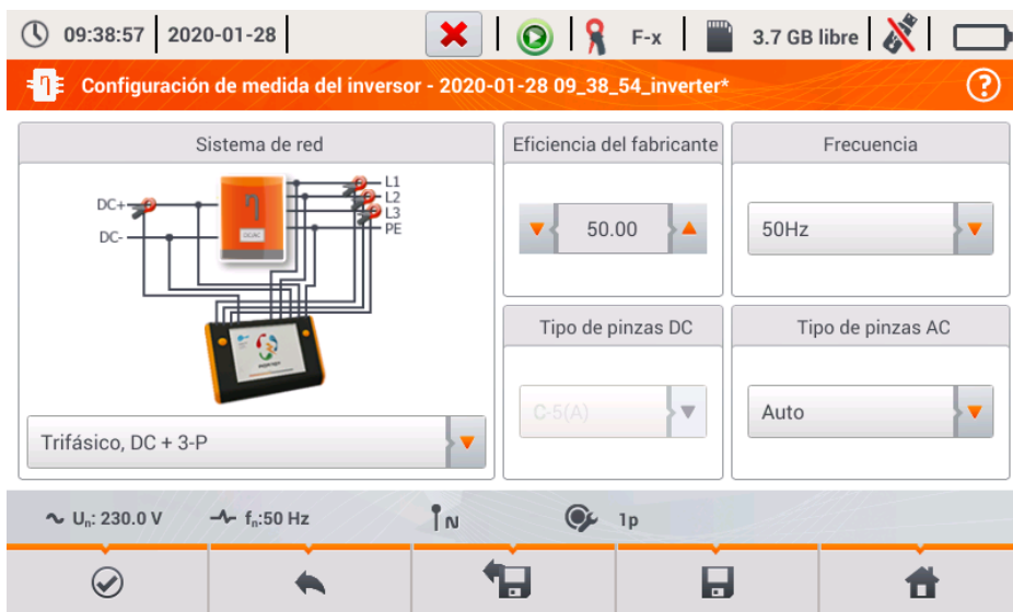
Fig. 45. Pantalla de configuración de la medición de la eficiencia del inversor.
