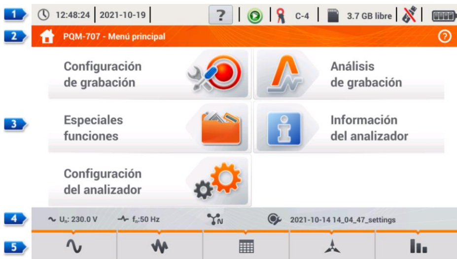
Fig. 2. Principales elementos de la pantalla del analizador.
