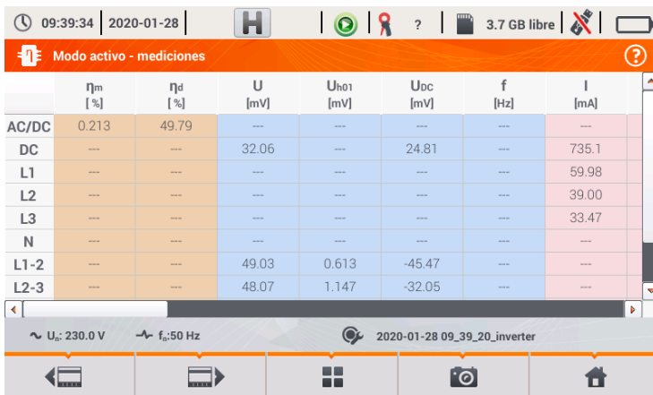
Fig. 47. Lecturas actuales en vista tabular en el modo de medición de la eficiencia del inversor.
